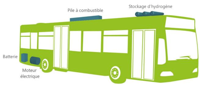
Figure 4 – Composants d'un bus à hydrogène (source : programme CHIC – Clean Hydrogen in European Cities)
