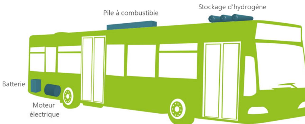
Figure 4 – Composants d'un bus à hydrogène (source : programme CHIC – Clean Hydrogen in European Cities)
