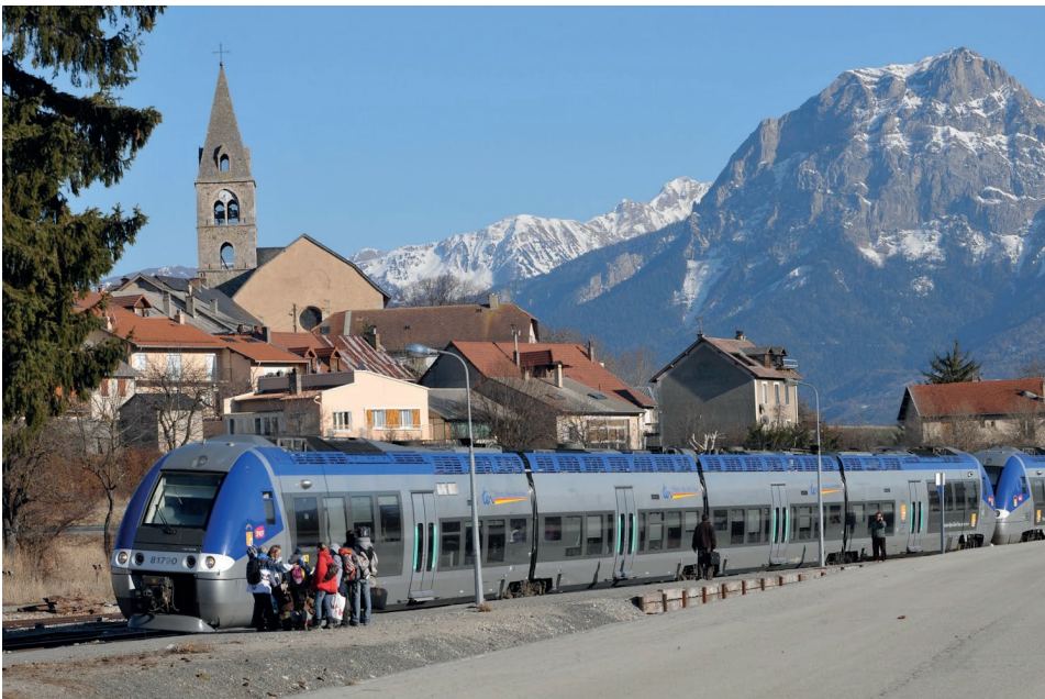
Photo 7: Train à moteur diesel, sur une ligne sans caténaire
